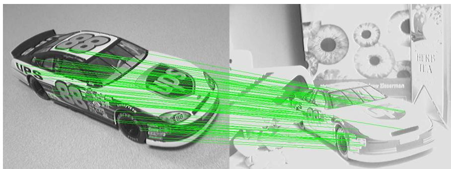
FIG. 9.12 – Appariement dans des conditions d’illumination extrêmes
